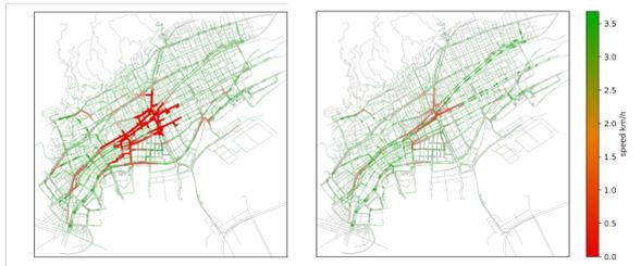
図 4: 遅延なし(左)・あり(右)による混雑状況の比較。4分ごとに赤信号へ変化する瞬間のスナップショットの、全シミュレーション時間による画像平均。
