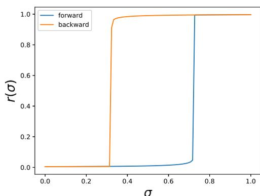
図 5: ヒステリシスの例。 $\sigma$  を 0.01 ずつ変えながら、各  $\sigma$  の値で 100 ステップ経過後の出力  $r$  をプロットしている
