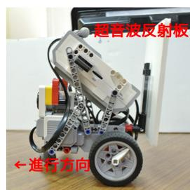
図 1: 後方に反射板をとりつけた最適速度ロボット
