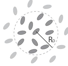
図 1: 局所密度の定義。 $i$  番目の粒子の周りの局所密度を、 $\rho^{(i)} = N_i/(\pi R_D^2)$  によって定義する。ここで、 $N_i$  は粒子の重心から半径  $R_D$  の円に含まれる粒子数である。ただし、 $N_i$  に  $i$  番目の粒子自体は含まれないとする。
