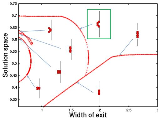
図4: アーチ粒子数4の分岐図（横軸：出口の幅，縦軸：解空間）．
