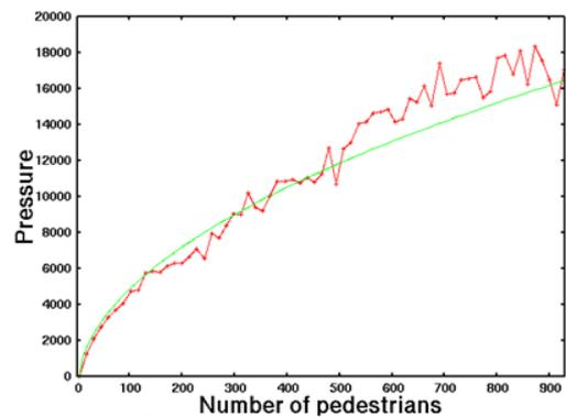
図 2: 近似粒子外力関数 (3) とシミュレーションで得られたアーチ粒子に加わる粒子外力値の比較 (緑曲線: 近似粒子外力関数, 赤曲線: 粒子外力値．横軸: 部屋に居る総粒子数, 縦軸: 各アーチ粒子に対する粒子外力の大きさ) ．
