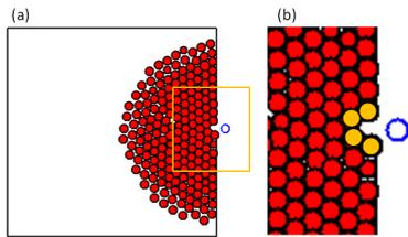
図 1: (a): SF モデルによる避難シミュレーションのある時刻におけるスナップショット (粒子数 200, 願望速度 5.0 m/s) ． (b): 出口付近の拡大図．出口付近に 4 粒子がアーチ状に並んでいる様が見られる．
