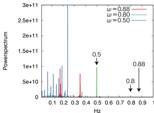
図4:  $i = 999$ の素子のパワースペクトル.  $A = 5, \alpha = 3$ で、 $\omega = 0.80, 0.88$ は奇妙な相、 $\omega = 0.5$ は周期的な相のパラメータである.  $t = 5000$ まではトランジェントとし、 $t = 5000$ から  $t = 15000$ までの振幅の変化により計算した.
