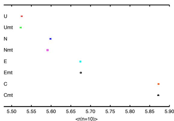
図 1: 各分布の  $\langle r(n = 10) \rangle$  の信頼区間の比較。縦軸の各記号は、(2)式~(5)式のすぐ下で説明したもの。これらの記号に MT とついているものは MT 法、ついていないものが線形合同法を用いている。
