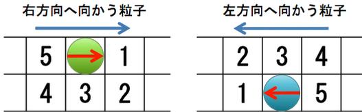
図1: 進路選択の方法。粒子の進行方向を前方として、1) 前方のセル・2) 斜め前方のセル・3) 真横のセル・4) 斜め後方のセル・5) 後方のセルの順に近傍のセルに粒子がいるかどうかの判定を行い、粒子がいない近傍のセルのうち最も番号の小さいセルを進路として選択する。
