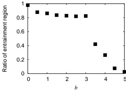
Fig.11:  $b=b_1=b_2$  の時、 $b$  の変化に対する同期領域の変化
