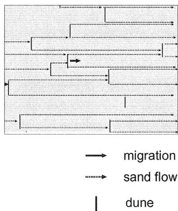
図 7: 2次元模型の概念図。縦の線は各々のバルハン砂丘を表し、矢印はバルハン砂丘の移動（太い矢印）とサルテーションによる砂丘間の砂のやりとり（破線矢印）を表す
