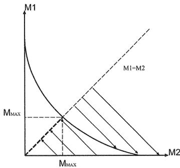
図 6: 2 砂丘系を 2 次元力学系と見た場合の位相プロフィール。ただし  $J'(H_1) > J'(H_2)$  とした。
