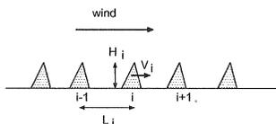
図 1: 一次元砂丘群模型の概念図
