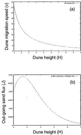
図 2: (a) バルハン砂丘の移動速度 ( $v$ ) と高さ ( $H$ ) の関係。および (b) 砂の流出量 ( $J$ ) とバルハン砂丘の高さ ( $H$ ) の関係
