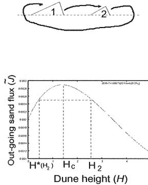
図 5: 衝突が起こらない場合の 2 砂丘系のダイナミクス。2 つの砂丘の高さが  $\bar{J}(H_1) > \bar{J}(H_2)$  を満たすとき、砂丘 2 は成長、砂丘 1 は縮小。1, 2, を置き換えても同様の議論ができる。一方、 $\bar{J}(H_1) = \bar{J}(H_2)$  の場合はつりあいの状態ではいずれの砂丘のサイズも変化しない。微小な変動に対する安定性は  $\bar{J}'(H_1) - \bar{J}'(H_2)$  の符号による。ただし、 $\bar{J}'(H)$  は  $\frac{d\bar{J}(H)}{dH}$  を意味する。(文中では H を M (砂丘の質量) と置き換えて  $\bar{J}$  を  $J$  と置き換えて議論している。ただし砂丘の高さの二乗と砂丘の質量は比例するものと仮定した。)
